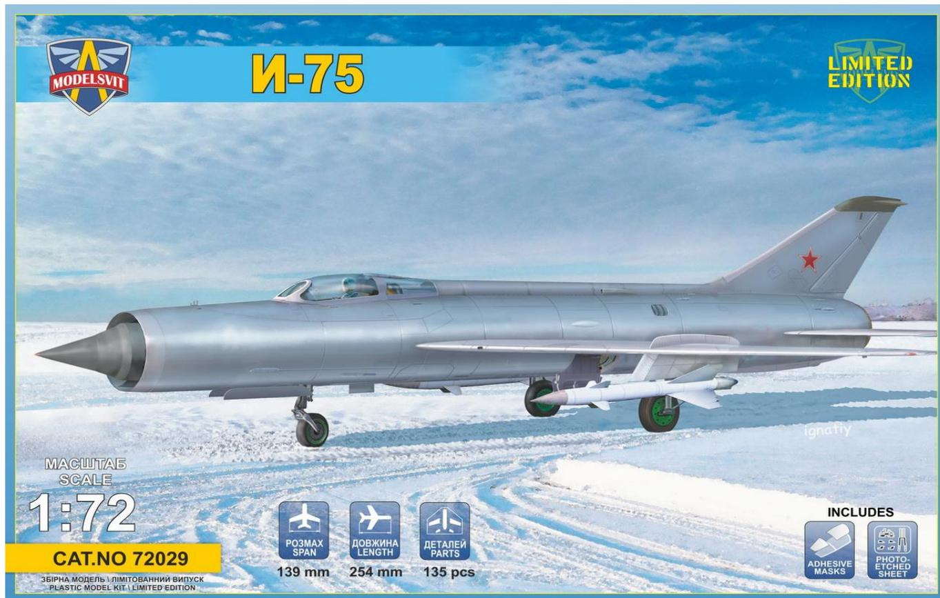
ミコヤン・グレヴィッチ I-75試作迎撃機はマッハ2級の超音速試作迎撃機、I-7シリーズ最後の機体です。1958年1月にテスト中のI-7Uの機体を改造・改良し、強力なリューリカ AL-7F-1エンジン(最大推力9,215kg)と「ウラガン」迎撃システムを装備、1958年4月にI-75として初飛行しました。武装はK-8空対空距離セミアクティブレーダー誘導ミサイル2基を搭載していました。「ウラガン」迎撃システムは地上から機体を敵機まで誘導、マッハ1.5と高度1万メートル以上で敵機を迎撃しその後撤退するという一連の動作を全て自動で行うというものでした。テスト中のI-75は素晴らしい性能を見せましたが、「ウラガン」迎撃システム自体の開発が遅れ1959年に計画が中止されました。このインジェクションプラスチックキットにはエッチングパーツ、塗装マスクシール、2種類のキャノピー(開・閉オプション)、2基のK-8ミサイルと1種類のデカールが付属しています。パーツ数は約135個で、完成時には全幅139mm、全長254mmとなります。
