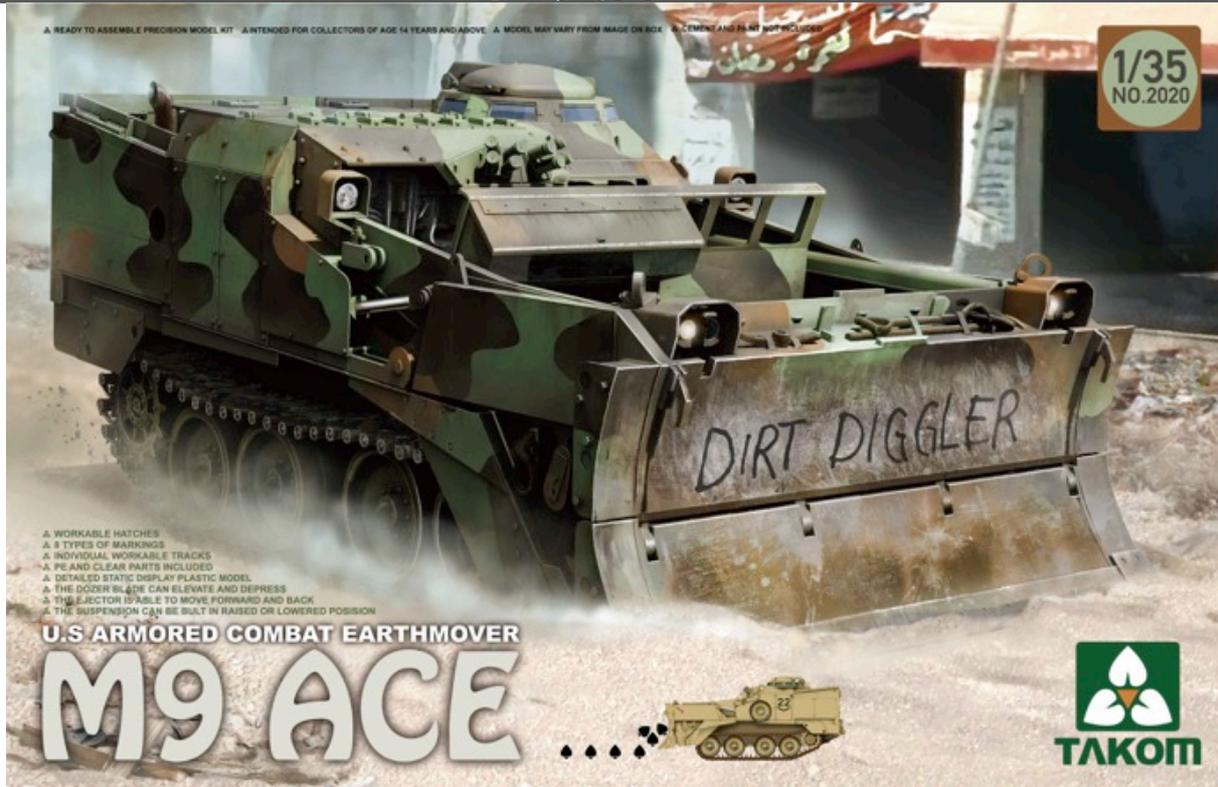
タコムの新製品、M9 ACE(Armored Combat Earthmover)はアメリカ陸軍の工兵部隊が使用している装甲ブルドーザーです。ドーザーを持ちその後ろには容積6.7立方メートル、9トンの土砂を積載可能なスクラップパー・ボウルを備えています。C-130輸送機で空輸可能、装甲は砲弾の断片と小銃弾に対して全周囲防御能力を持っており、最前線での運用を想定しています。一般的なブルドーザーと比べると機動力は高く最高速度は50 km/hになり不整地でも機甲部隊に随伴する能力を持っています。
