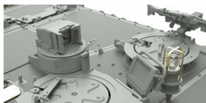
砲塔上の赤外線暗視装置と車外ディスプレイ
