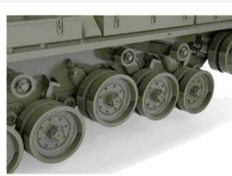
可動組立式履帯を活かすサスペンション可動
