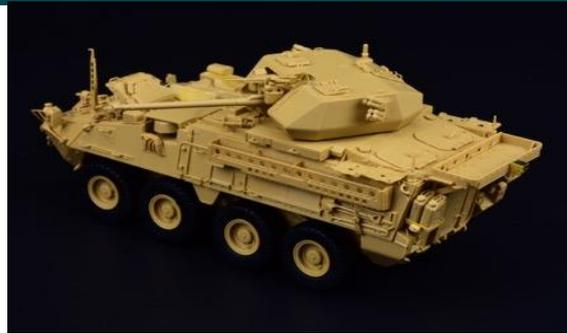
ストライカーはLAV-IIIをベースに開発されたアメリカ陸軍の装輪装甲車ファミリーで、ドラグーンはM1126ストライカーICVの遠隔操作銃塔をMk 44 ブッシュマスター II 30mm機関砲搭載のコングスベルク社製無人砲塔に換装した武装強化型です。
