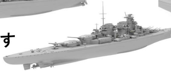
H級戦艦はビスマルク級戦艦に続いて第二次世界大戦中にドイツ海軍が計画していた超弩級戦艦の艦級です。H級戦艦建造はドイツ海軍が1939年から予定していた海軍拡張計画であるZ計画の一環であり、完成すれば5万トンを超える大型戦艦になる予定でした。仮称艦名「H」は1937年に予算承認され1939年に起工されましたが、第二次世界大戦の勃発により建造が中止、1941年に解体されました。その後も戦艦建造再開に備え「H41」～「H44」と呼ばれる改良設計案が検討されました。当初の設計であり策定年度から「H39」と呼ばれた設計案は船体や兵装などは基本的にビスマルク級を踏襲し、16万5000馬力を発揮する12基のMAN社製ディーゼルエンジンにより長大かつ高速の巡航能力を獲得する予定でした。その後「H39」を改良した設計案である「H41」～「H44」は年度が変わる毎に兵装、防御要綱が拡大していきました。
