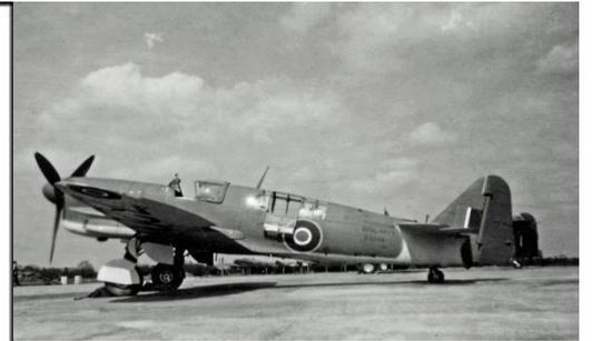
フェアリー ファイアフライはフルマー戦闘機の後継機として開発され、イギリス海軍の艦隊航空隊などで運用された複座艦上戦闘機です。本機はフルマーよりも重かったものの、空力的に洗練された機体形状とフルマーよりも出力が上昇したエンジンにより、最高速度はフルマーMk. IIよりも60km/hほど上昇しました。1943年10月に実戦配備されるとノルウェー沿岸における武装偵察や敵船舶攻撃などを行い、1945年には太平洋に進出しました。戦後はイギリス海軍をはじめカナダやオーストラリア、英連邦以外ではオランダが運用し、1950年代にガネットと交換されるまで前線任務で使用されました。
