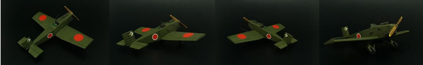
夕号試作特殊攻撃機は太平洋戦争末期に日本陸軍によって開発された特殊攻撃機です。本機は陸軍航空技術研究所により1945年2月に開発が始まり、日本国際航空工業と立川飛行機の両社に開発が指示されました。日本国際航空工業製の夕号は全長5mほどの単座機で、発動機は同社の四式基本練習機と同じ「ハ47」、武装は100kg爆弾を1つ装備しました。主翼はテーパー翼の低翼単葉で、掩体壕に隠蔽できるように外翼を人力で上方に折りたたむ事が可能でした。主脚は固定式で尾輪は無く尾そりを採用していました。機体は疎開工場でも生産しやすい為と金属の使用を抑える為に全木製で胴体は木製骨組みに合板張りもしくは羽布張り、主翼や水平・垂直尾翼は木製骨組みに羽布張りだったのではないかと推測されています。プロペラは木製の固定ピッチ2翅でした。試作初号機は1945年6月に完成しましたが、量産されることなく終戦を迎えています。
