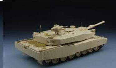
レオパルト II レボリューションはRLS社が2010年の「ユーロサトリ2010」兵器展示会で発表した、IBD社の追加装甲パッケージ「AMAP」(Advanced Modular Armor Protection)を導入したレオパルト2A4エボリューションに、各種センサーの導入や空調設備の強化、電子機器の追加に対応するための大容量のAPU(補助動力装置)を追加したレオパルト2の近代化改修型です。FCSはデジタル式FCSに換装され、砲塔前面の左右にアクティブ防御システムを装備、砲塔上面には武装ステーションを搭載しています。キットは130mm L/51滑空砲を装備した姿を立体化しています。エッチングとデカール、ワイヤーとポリキャップ付属。
