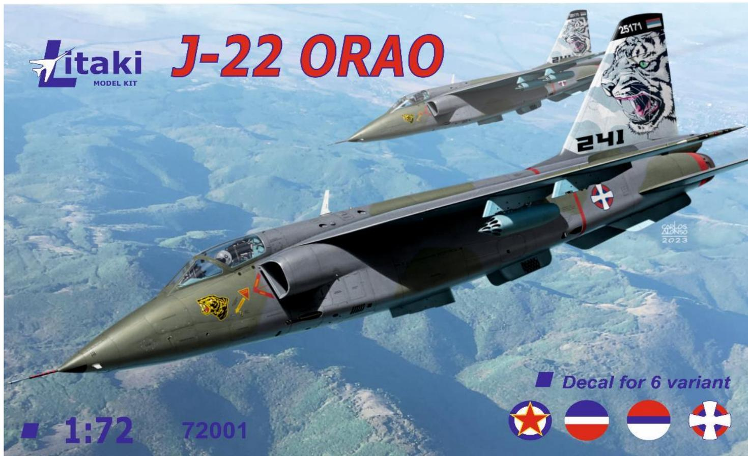
実機諸元: ・全長: 14.9m ・全幅: 9.62m ・エンジン: ロールス・ロイス バイパー633 x 2
