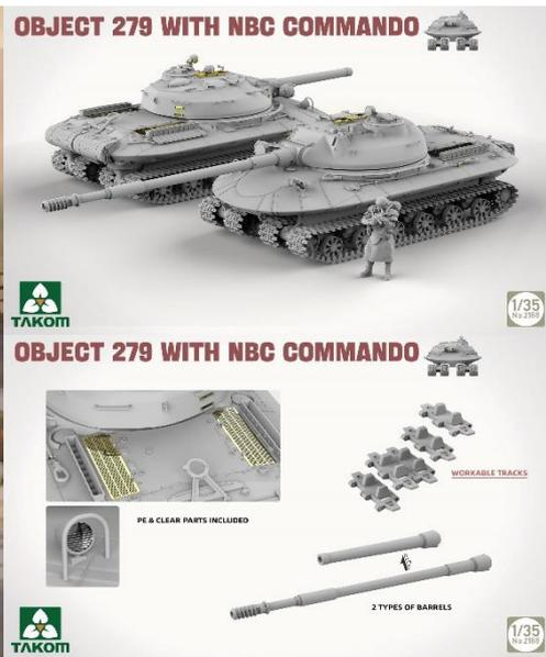
オブジェクト279は1950年代に開発されたソビエト連邦の試作重戦車です。1950年代のソ連では新型重戦車の開発プランがいくつか進行しており、その内の一つ「核戦争下での活動を考慮した重戦車」として開発されたのがオブジェクト279です。核爆発時の爆風や衝撃波を受け流して車体が横転しないよう円盤のような流体曲面の車体に左右2本ずつ、計4本の履帯を持つなど独特な形状をした本車は、1959年に試作車が完成し各種の試験が行われると、4本の履帯による軽戦車並みの接地圧と大出力のエンジンにより悪路での機動性の高さを示すなど良好な試験結果を残しました。ですが構造が複雑で生産コストが高すぎることで、水陸両用性能がなく大河に隔てられた地形での行動能力に疑問が持たれた為、制式採用および量産はされませんでした。
