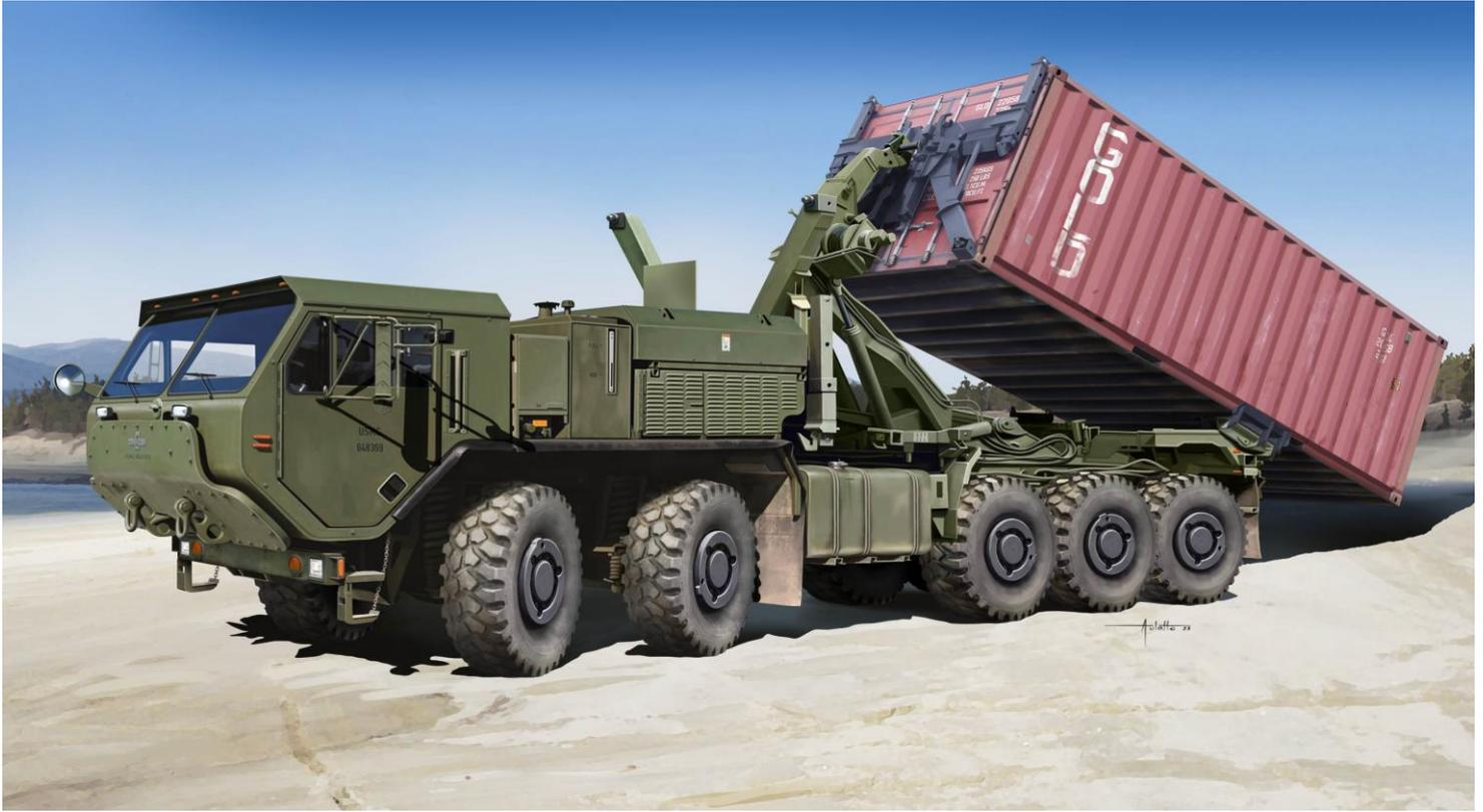
LVSR(Logistics Vehicle System Replacement)はアメリカで開発され、アメリカ海兵隊で運用されている8輪構造の輸送用大型軍用車両であるLVS(Logistics Vehicle System)の連結機構を廃し、10×10輪駆動に改良した車両です。2009年に実戦配備された本車は前部・後部の連結機構を廃止し10×10輪駆動の通常のトラックの構造となることで陸軍のPLS(Palletized Load System)とほぼ同様の車両になっている他、MTVR(Medium Tactical Vehicle Replacement)と同様のサスペンションシステムの採用、装甲銃塔の搭載、追加装甲キット適用などの改良が行われており、米海兵隊のアフガニスタン紛争への作戦にMTVRやMRAP、M-ATVと共に派遣され実戦で使用されています。MKR18はコンテナの積み下ろしのため、荷台部分に積み下ろし機構を備えたトレーラーユニットで、荷台全体を後ろに傾けることで大型のアームでの積み下ろしが可能となっています。
