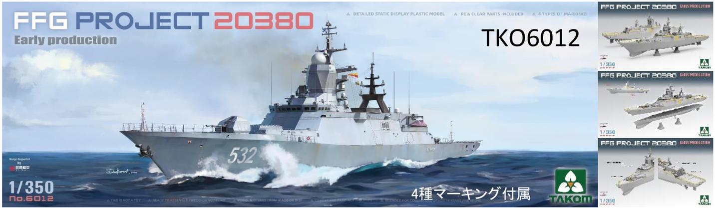
プロジェクト 20380 フリゲートはロシア海軍のフリゲートで、海軍での正式名は20380型警備艦です。沿海用の汎用警備艦として計画された本級はステルス艦として設計され、上部構造物には複合材が導入されました。また対潜哨戒を主務とする為、主船体への新型鋼材を採用したことで船殻重量の軽量化が達成されました。艦級のネームシップであるステレグシュチイの建造は2001年に開始され、2008年に就役しました。
