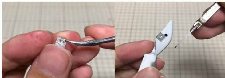
3.今回は0.6mm幅のスジボリ用工具を使用します。開口部の長方形の端側からスジボリ用工具を引いて彫るようにし、片側を3~5回彫ったらパーツの向きを180度回転して反対側を彫るようにします。この作業を数回繰り返して任意の深さに彫り込みます。
