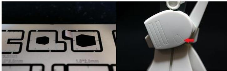
使用例3: 画像の二本のラインが平行に並んだピースを使用して、長方形の凹モールドを彫り込んだ例。エッチングガイド04には彫り込むラインの幅が4サイズ、ラインとラインの距離が異なるものが2種類の計8ピース収録されています。
