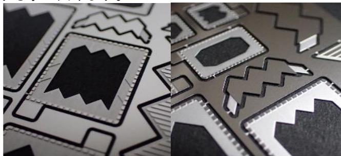
パネルラインのスジ彫りのテンプレートとしてだけでなく、キット改造時の開口のガイドとして使用してみます。このような複雑な形状は、ガイドテープの貼り重ねでは角度や辺の長さを揃えるのがかなりの労力でした。こちら瞬間接着剤で固定して、スジボリ用工具で軽く何度もケガキます。
