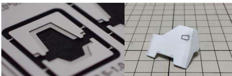
使用方法は大きい台形のピースの位置合わせをしてから、凸凹のつなぎ目を合わせ小さいピースを貼り付けると上手く二面に貼り付けられます。あとはスジボリ用工具を内側のラインに沿って引くように彫れば、綺麗なパネルラインが完成します。
