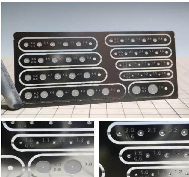
本商品はプラモデルの円柱パーツや、プラ棒の中心にピンバイスで穴を開けるためのエッチング製のテンプレートガイドです。厚さ0.4mm、エッチングのハーフ(段差)を利用して0.2mmの高さがあれば穴開け作業が可能です。プラモデルのキットの製作や、改造をしていて円形のパーツをディテールアップしたい時や、キャラクターモデルキットの関節を延長したい時など、円の中心にピンバイスを使用して穴あけをすることが多々ありますが、正確に中心に開孔するのは難しく、また円の直径が小さければ小さくなるほど難易度も上がっていきます。そこで円柱のパーツにエッチングの窪みを合わせるだけで簡単に中心を出せる治具(ガイド)を製品化しました。
