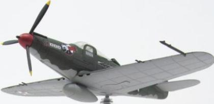
P-39 エアロコブラはベル社が開発し、第二次世界大戦初期にアメリカ陸軍航空軍等で運用された戦闘機です。本機は高々度迎撃機として設計され、運動性の向上のため操縦席の後に液冷式のエンジンを置き、プロペラ軸を通して装備される37mm機関砲を機首に装備するといったレイアウトを取っていました。アメリカや輸出先のイギリスよりも4,700機以上生産されました。
