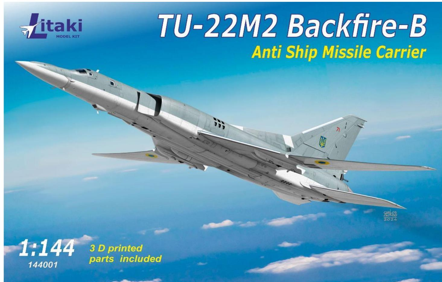
実機諸元:・全長:41.48m・全幅:34.28m・エンジン:クズネツォフNK-22 ターボファンエンジン x 2・乗員:4名・最大速度:マッハ 1.65・自衛武装:GSh-23 23mm機関砲 x 2
