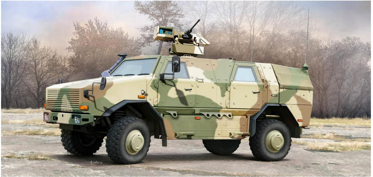
ディンゴはドイツで開発された歩兵機動車で、ディンゴ2はユニモグU5000のシャシーを流用することで搭載量を向上させ、併せて装甲防御力も強化した改良型です。PatSi(Patrouillen und Sicherungsfahrzeug = 哨戒/警備車両)はその派生型で、本車の車体上面にはFLW200武装ステーションが装備されており、車内からの遠隔操作により射撃を行うことが可能です。搭載された直列4気筒液冷ターボチャージド・ディーゼル・エンジンと、8段変速のトルク変換機付き自動変速機の組み合わせのパワーパックにより、路上最大速度95km/h、路上航続距離1,000kmを可能としています。NBC防護装置も標準装備したディンゴ2は、2004年にドイツ陸軍と国境警備隊が導入し、その後オーストリアとベルギー、チェコ、ルクセンブルク、ノルウェーが採用を決定することで運用国は6カ国となっています。
