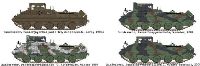
ヤグアル1はラケーテンヤークトパンツァー3とも呼ばれる、HOT (Haut subsonique Optiquement Téléguidé=光学誘導亜音速ミサイル) 対戦車ミサイルを装備した西ドイツの対戦車車両です。本車はラケーテンヤークトパンツァー2に装備されたSS.11対戦車誘導ミサイルをHOT対戦車ミサイルに換装、装甲を強化するなどのアップグレードがされた車両で、1978年～1982年にかけて316両が改修されました。ドイツ陸軍に採用されたヤグアル1は1993年から1995年までの間に新しい光学・FLIRシステムが採用され、2005年までには順次退役しました。また、オーストリア軍の一部が売却されました。
