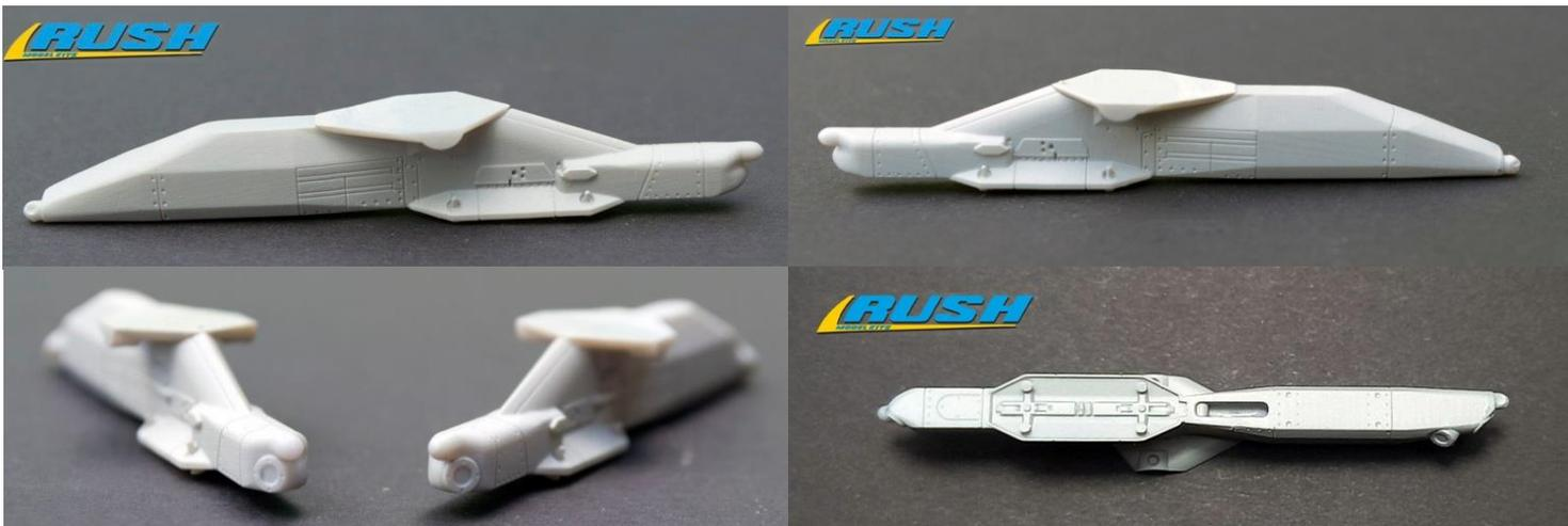
ECIPS+(パイロン一体型電子戦システム、ミサイル警戒装置付き)は、イスラエルのエルビット・システムズ社とそのパートナー、デンマークのテルマ社が共同生産しているシステムで、数年前から欧州諸国が運用するF-16に装備され始めました。ECIPS+はチャフやフレアによるアクティブ防護を補完するパッシブ防護として、地上などのレーダーを無効化するAN/ALQ-162ジャマー(電波妨害装置)などを備え、またAN/AAR-60ミサイル警戒装置も装備しています。ECIPS+はデンマークがウクライナに供与したF-16Aにも装備されており、また米空軍予備役軍団と米空軍州兵も導入を検討しています。
