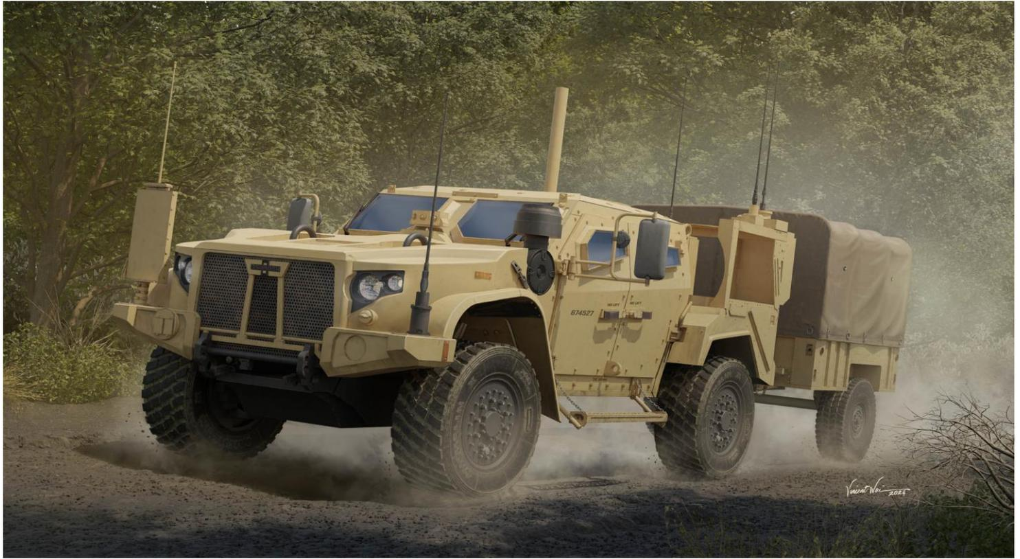
アメリカでM35 2.5tトラックとM939 5tトラックの後継として開発された軍用の積載量2.5tおよび5tトラックシリーズはFMTV (Family of Medium Tactical Vehicles=中型戦術車両ファミリー) と呼称されています。FMTVは4×4輪駆動の2.5tトラック型と、6×6輪駆動の5tトラック型が共通のシャーシから開発され、基本形のカーゴトラック型をはじめとして、ダンプトラック型やショッパン型、トラクター型など様々な派生型が開発されています。その内の4×4輪駆動の2.5tトラックタイプはLMTV (Light Medium Tactical Vehicles) と呼称され、M1280はJLTV-GPをベースとした乗員4名の汎用の多用途車両です。軽戦術トレーラー (Light Tactical Trailer: LTT) は1軸2輪のトレーラーです。
