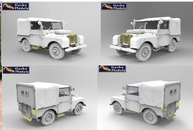
FV18001は第2次世界大戦中に活躍したアメリカの4x4ユーティリティトラックを参考に、イギリスで開発された車です。大戦後に自国で4x4ユーティリティトラックを開発・生産する「FV1800計画」が始動すると、1948年にイギリスの自動車メーカーがラダーフレームのシャシーにアルミ合金ボディを架装し、1.6リッター直4ガソリンエンジンを搭載した車両を開発しました。本車は1949年に英国陸軍に採用されると、朝鮮戦争やスエズ危機などで運用されました。
