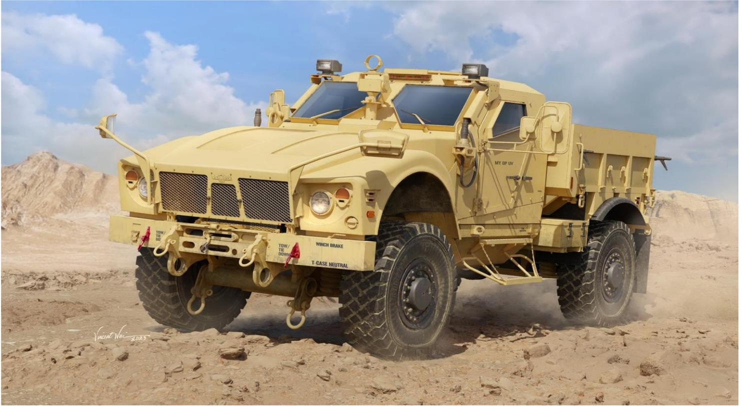
M-ATV(MRAP All Terrain Vehicle)は、アメリカで開発された4×4輪駆動の耐地雷/伏撃防護装甲車です。本車はM1114やM1151などの装甲型ハンヴィーの後継として、従来の大柄で重量のあるMRAPの車種と同等の防御力を持ちながら、より高い機動性を求めて計画された“MRAP (Mine Resistant Ambush Protected) All Terrain Vehicle”計画開発された車種です。1/35 M-ATV カーゴキャリアは車体後部に貨物用プラットフォームを搭載したタイプです。
