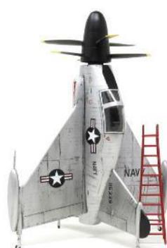
XFY-1は米海軍が計画し、コンベア社が製作した垂直離着陸戦闘機で、愛称はポゴです。本機は機首を上に向けて垂直に離陸後、空中で姿勢を水平に転換し通常の航空機と同じように飛行するテイルシッター型を採用しています。急激な失速をせず垂直離陸から水平飛行への転換の際に有利なデルタ翼と機体の上下に大きな垂直尾翼を持ち、アリソン製ターボプロップエンジン2基を連結した強力な発動機で2重反転プロペラを回転させるXFY-1は1954年8月に初飛行すると、同年11月には垂直に離陸し空中で姿勢を転換して水平飛行し、再び垂直になって着陸する「転換飛行」にも世界で初めて成功した機体として広く知られています。
