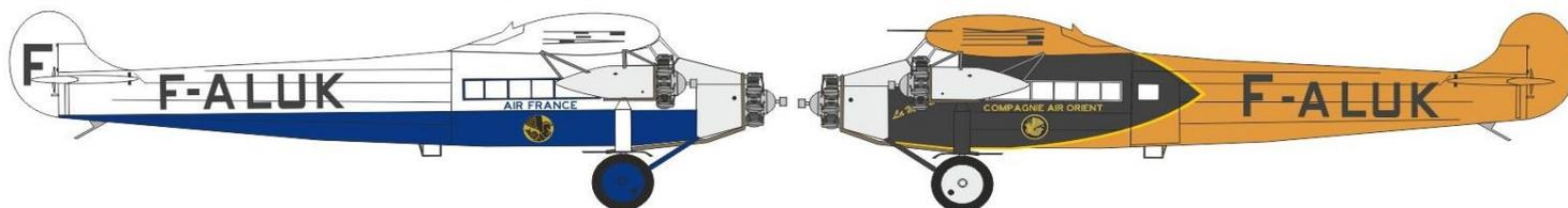
実機諸元：・全長：14.50 m・全幅：21.71m・エンジン：ライト・ワールウィンド空冷9気筒 220hp x 3・巡航速度：170 km/h・航続距離：1200km・乗員：2名・乗客：8名
