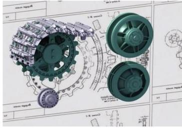
スプロケットホイール、アイドラーホイール、スペアトラックリンクホルダーとスペアトラックリンクを含む!
