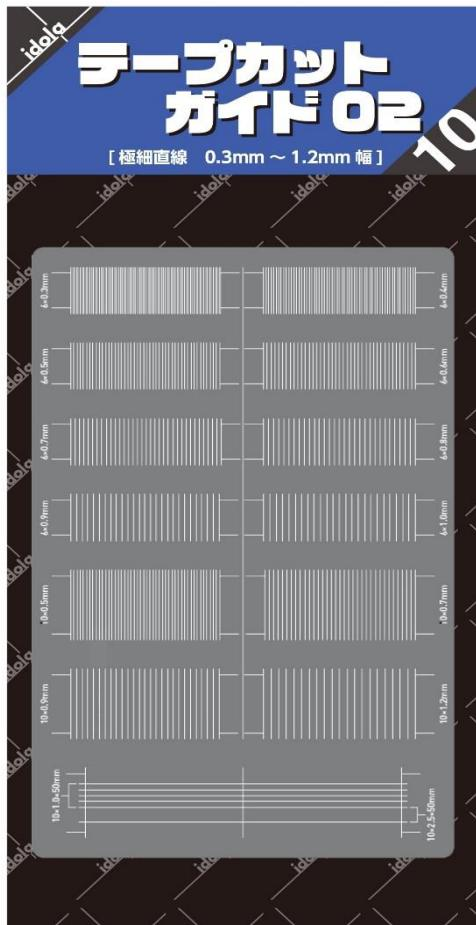
本商品はマスキングテープやマスキングシート、フィニッシュシート等を0.1mm間隔で極細幅ラインを大量に作成することができる、エッチング製のカッティングテンプレートガイドです。0.2mm厚のステンレス板に横幅6mmと10mmのスタンダードサイズのマスキングテープを、それぞれ1.0mm/1.5mm/2.0mm/2.5mm/3.0mm/3.5mm(テープカットガイド01)、0.3mm/0.4mm/0.5mm/0.6mm/0.7mm/0.8mm/0.9mm/1.0mm/1.2mm(テープカットガイド02)にカットできる溝が等間隔に彫られており、ガイドラインに合わせてマスキングテープを貼り付け、0.1mmの溝に沿ってデザインナイフなどでカットするだけで、手作業では難しい極細幅のテープが簡単に作成出来ます。またベースプレート型なので抜型と異なり、カットラインが歪む心配もありません。カット後はデザインナイフの先端やピンセット等で綺麗にはがして、塗り分けをしたいパーツに貼り塗装作業に入ります。
