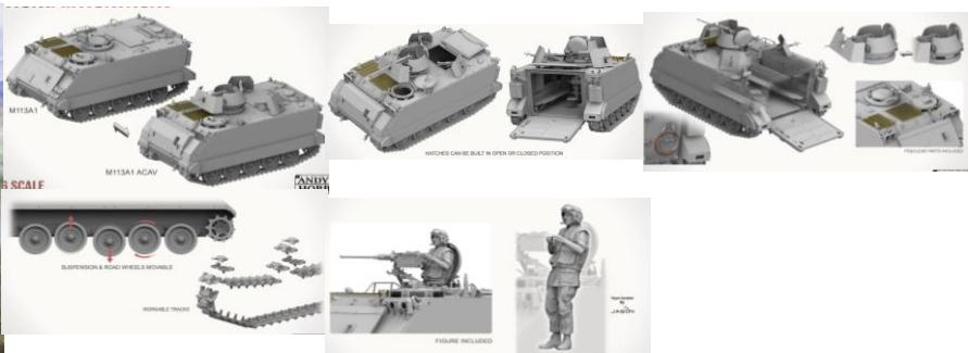
M113はアメリカで開発され、1960年に採用された装甲兵員輸送車です。M113は派生型を含め約80,000両以上が製造され、さまざまな戦闘や援護作戦に使用されました。M113A1はガソリンエンジンからディーゼルエンジンに換装されたタイプで、1964年に制式化されました。ACAV(Armored Cavalry Assault Vehicle=装甲騎兵戦闘車)はM113の車長用キューポラ周りに湾曲した装甲版と、12.7mm重機関銃M2に防盾を追加することで乗車戦闘の可能な歩兵戦闘車的運用を可能にした車両で、1963年に開発されるとベトナム戦争で運用されました。
