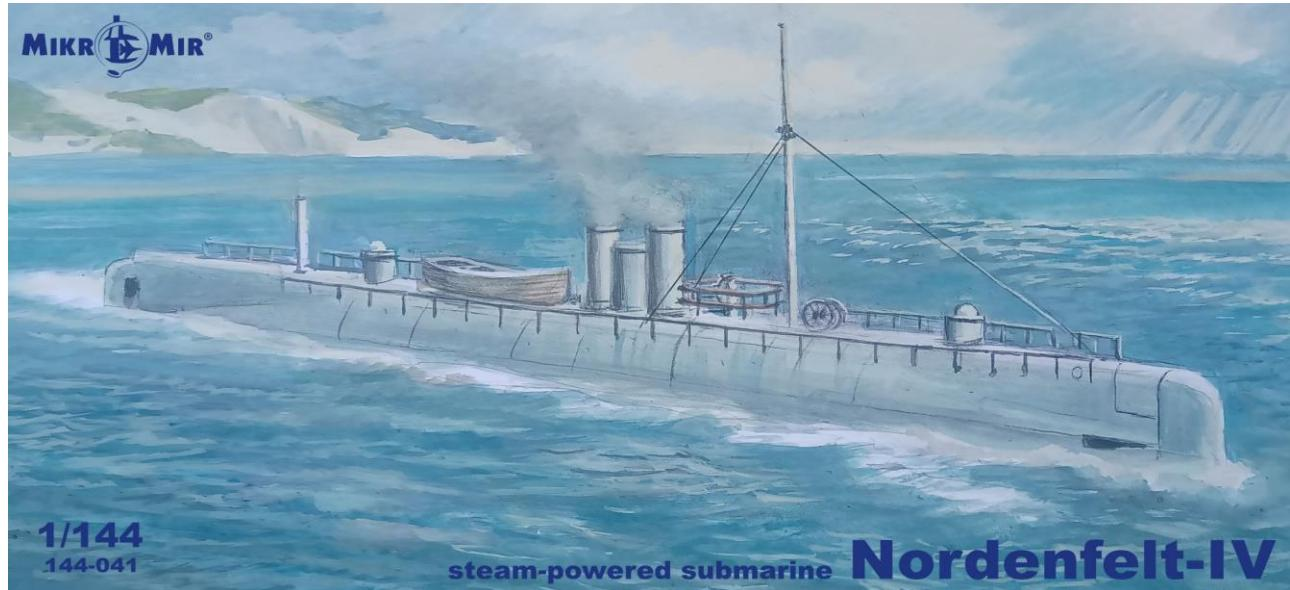
諸元: ・全長:38m ・排水量:245t ・機関:蒸気機関 x 2基
