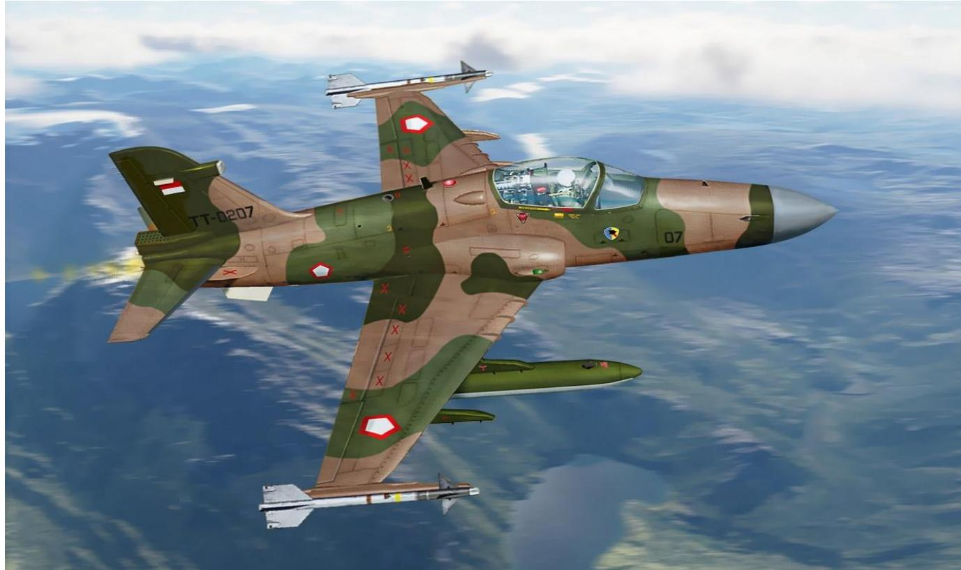
ホーク200はホーク100 複座練習機の機首を再設計し、固定機関砲とF-16にも使われているAN/APG-66Hレーダーを搭載、主翼も翼端にサイドワインダーランチャー、翼下には武装パイロンを装備するなどの再設計がされた単座戦闘攻撃機です。また固定型空中給油プローブの装備も可能となりました。1986年に初飛行したホーク200は1990年から2002年まで生産され、インドネシア空軍仕様の生産機はホーク209と名付けられました。キットには3種インドネシア空軍デカールが付属しています。
