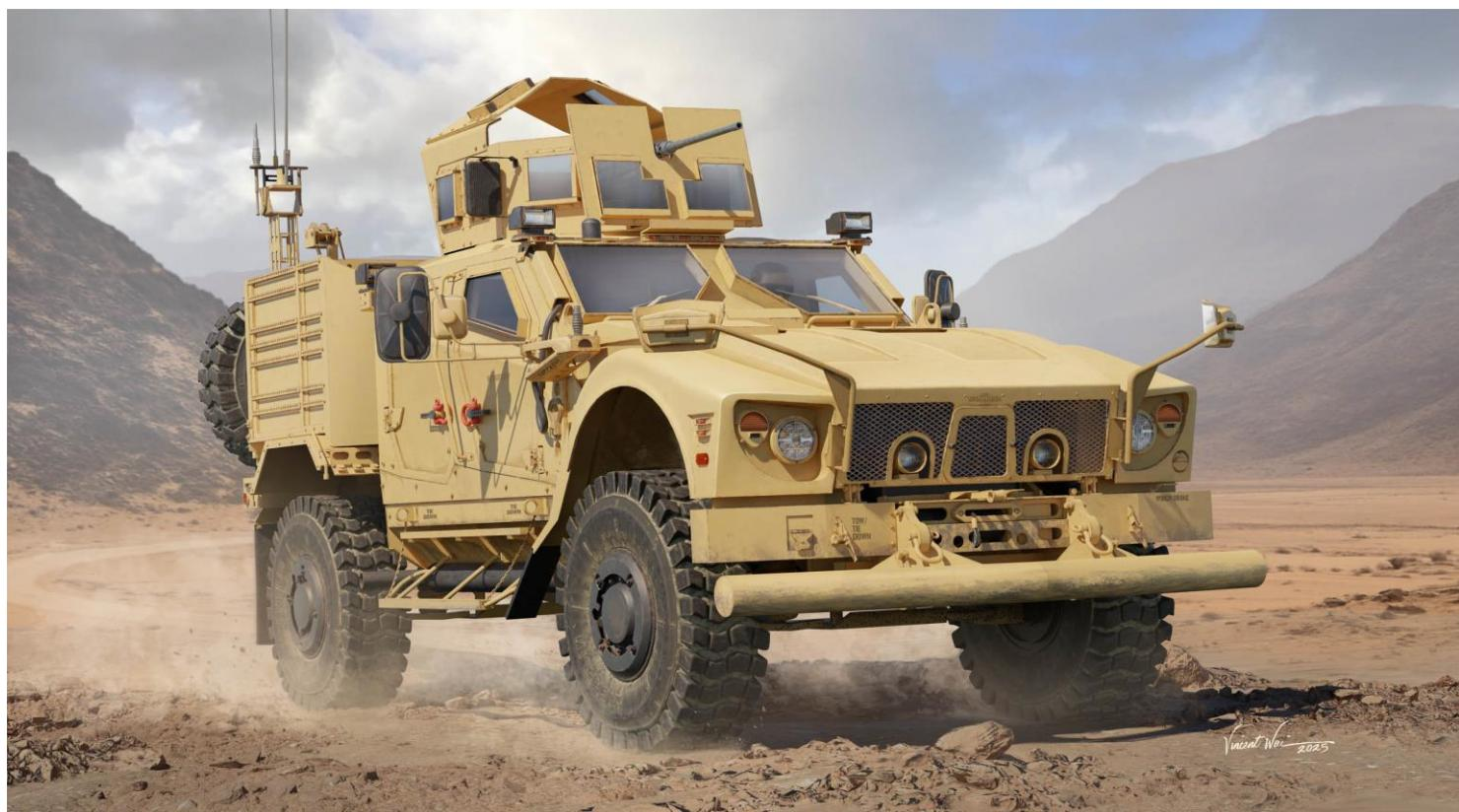
M-ATV (MRAP All Terrain Vehicle)は、アメリカで開発された4×4輪駆動の耐地雷/伏撃防護装甲車です。本車はM1114やM1115などの装甲型ハンヴィーの後継として、従来の大柄で重量のあるMRAPの車種と同等の防御力を持ちながら、より高い機動性を求めて計画された”MRAP (Mine Resistant Ambush Protected) All Terrain Vehicle”計画開発された車種です。M1245はアメリカ特殊作戦軍(SOCOM)向けの発展型です。
